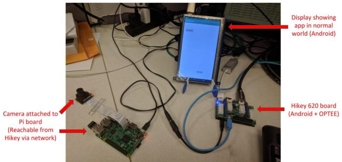
Fig. 5.22.: Camera Test Setup
