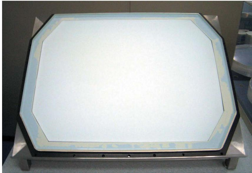
**Fig. 1.2.** NaI scintillation crystal. [5]
